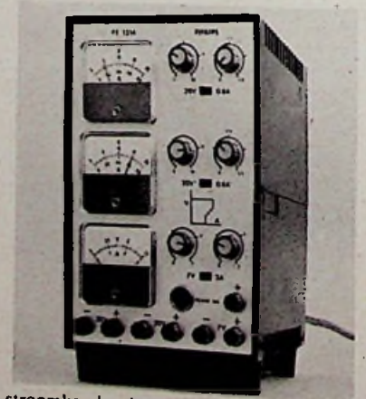
stroomkarakteristiek is volledige beveiliging tegen overbelasting en kortsluiting bereikt.
